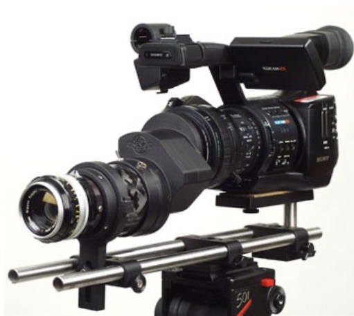
Slika 6 DOF adapter na kameri Sony EX-1 s 1/2" senzorjem
