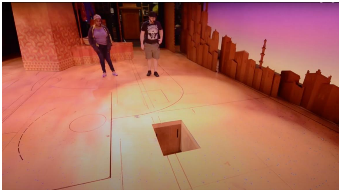
Slika 25. Brzi liftovi. Jedan je spušten, a drugi se nalazi u razini pozornice.
