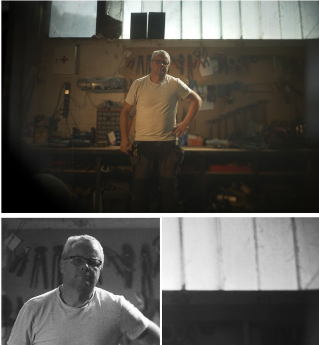
Slika 15 Na približenim dijelovima fotografije vidljive su linije uzrokovane grebenima Fresnelovih leća u obliku koncentričnih krugova
