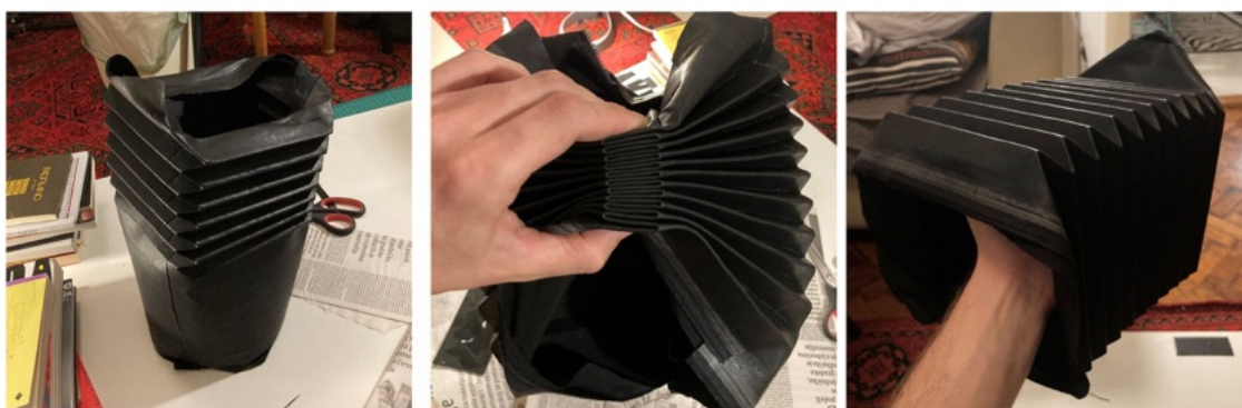
Slika 13 Preklapanje mijeha u konačni oblik
