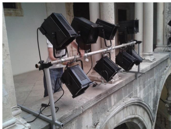
Slika 65: primjer improvizirane konstrukcije za rasvjetu
