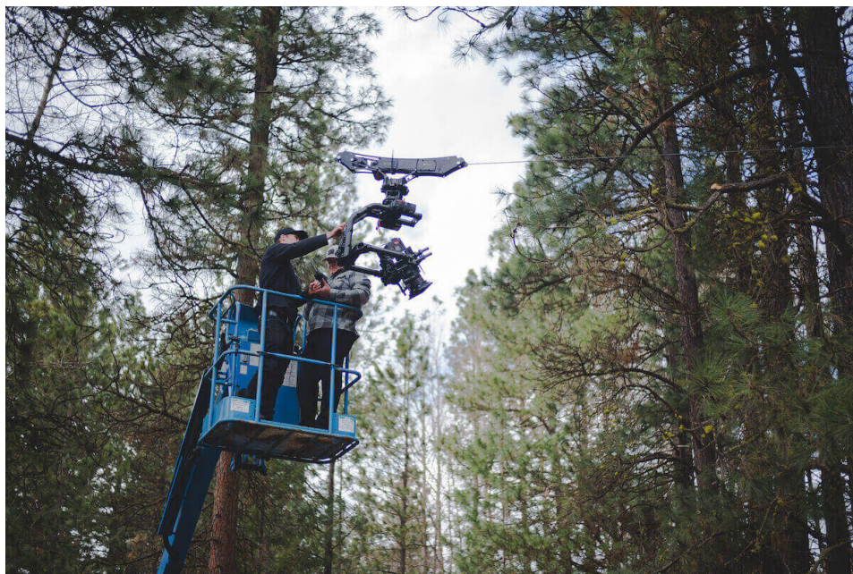
Slika 13 – Postavljanje Cablecam-a s fiksnim kablom
