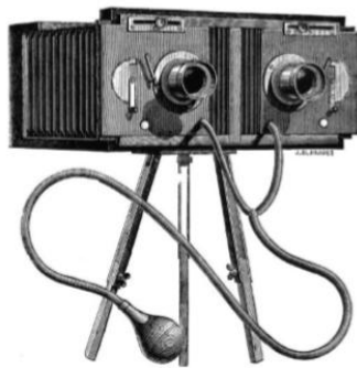
Slika 3. Stereoskopski fotoaparat Alberta Londe, 1893.
